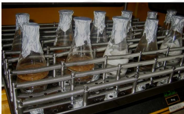
Obr. 1: Aerobní předúprava lignocelulosových substrátů.
