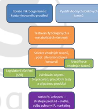
Obr. 2 schéma procesu „od laboratoře po lokalitu“ v rámci přípravy bioaugmentačního preparátu
