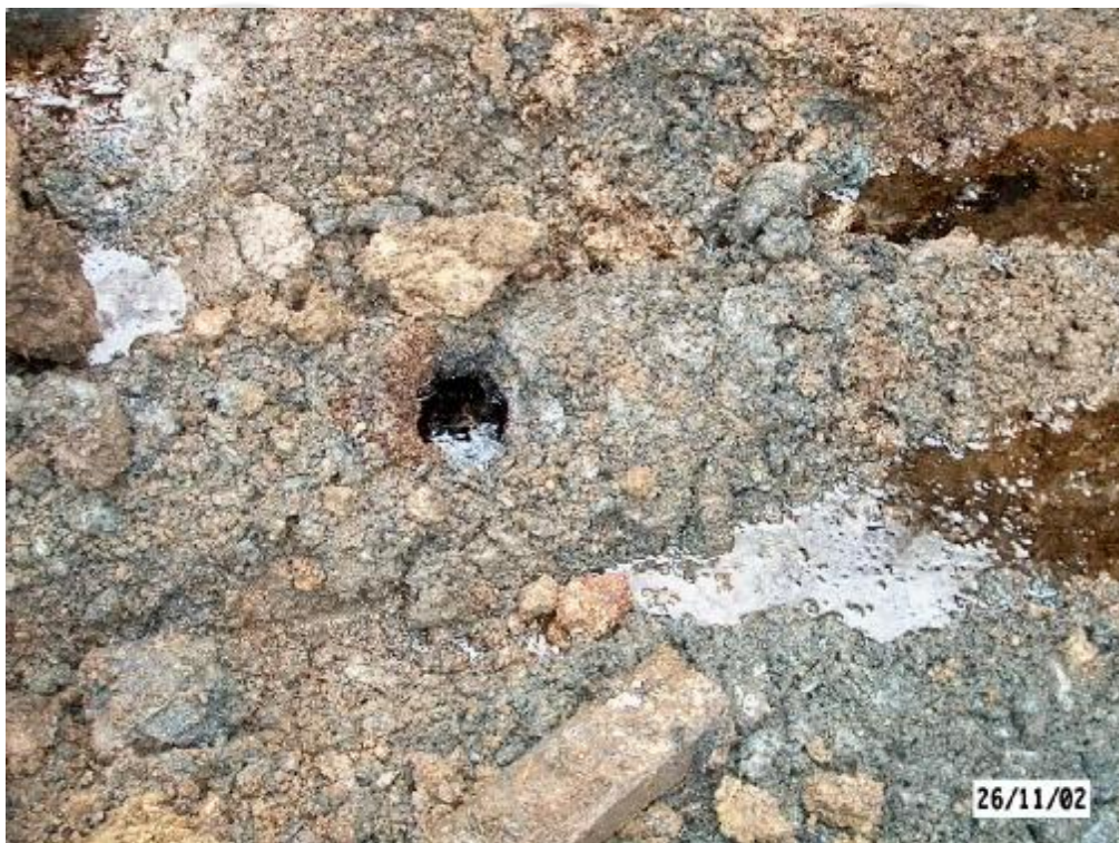
Foto č. 3: Akumulovaná volná fáze NEL v prostoru bývalé monitorovací sondy Východní oblast: Sanace zeminy břehu řeky Bíliny biodegradací in situ v Litvínově - Záluží Definitivní situace odtěžení kontaminovaných zemín a závěrečného vzorkování
